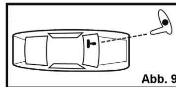
Wird die Alarmeinheit nicht innerhalb von 60 Sekunden nach Drücken des Druckschalters mittels Fernbedienung aktiviert, so schaltet die Alarmeinheit ab. In diesem Fall muss der Druckschalter an der Alarmeinheit erneut gedrückt werden um die Stromversorgung des Geräts einzuschalten.
