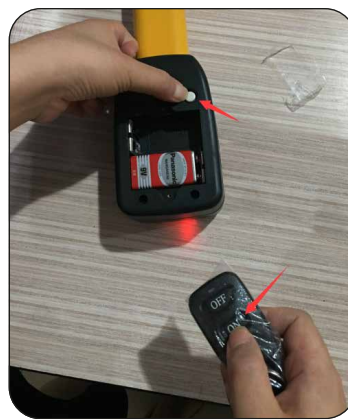
Den „ON“ Knopf und den weißen Knopf gleichzeitig drücken press „ON“ button and WHITE button together
